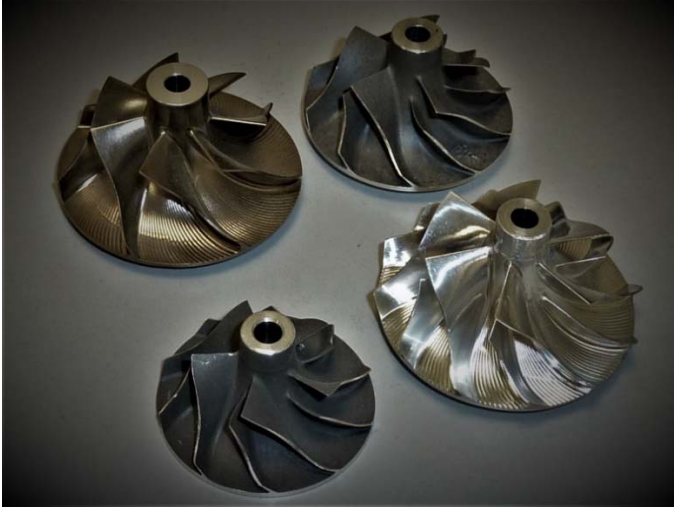
Kompresör arklarında 300.000 devri/dakikaya varan devir sayılarında optik frekans ölçümleri
