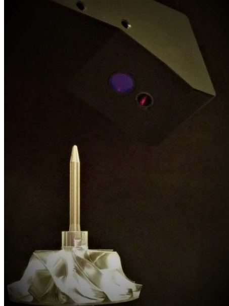
RED-110-P kenar detektörüyle büyük ölçüde yüzeyden bağımsız değerlendirme
